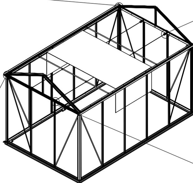
Fixez l'équerre avec la vis M6x12 et l'écrou frein déjà présents sur votre serre (à votre convenance, vous pouvez remplacer cette vis M6x12 par une vis M6x18 présente dans le kit du système d'ombrage). Puis fixez le tendeur à l'équerre.
