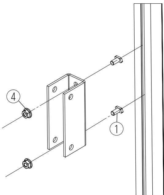
**2** Assemblez les consoles en utilisant l'entretoise (5), une vis tête H M6x35 (2) et un écrou (4) comme présenté sur le schéma.
