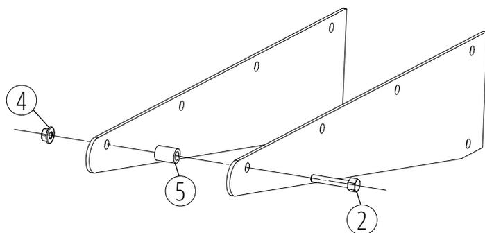
**3** Fixez la paire de consoles au U de fixation en utilisant une entretoise (5), une vis tête H M6x40 (3) et un écrou (4). Veuillez d'abord fixer le haut, puis le bas.
