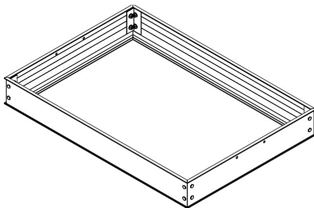
**2** A l'aide des vis à têtes marteaux (1) et des écrous (3), fixez les cornières (6) sur la largeur et les plats (5) en parallèle sur la longueur du bac.
