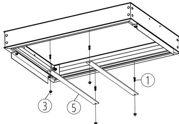
**3** Si vous le souhaitez, vous pouvez ajouter les poignées (7) en les fixant à l'aide des vis à têtes hexagonales (2) et écrous (3). Pour finir, posez la tôle de fond à l'intérieur du bac et posez celui-ci sur les consoles.
